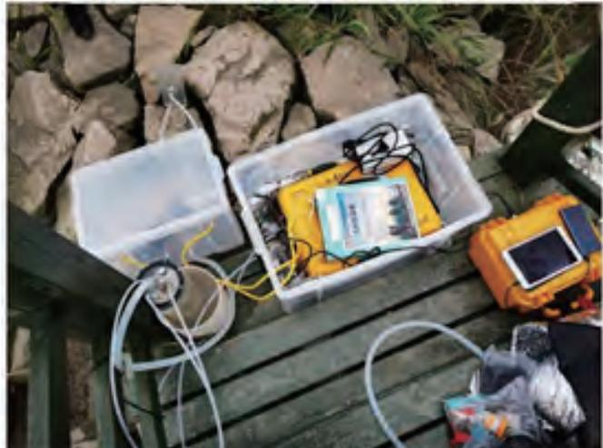
用自建pCO<sub>2</sub>原位连续观测系统观测溶解无机碳水平转移
